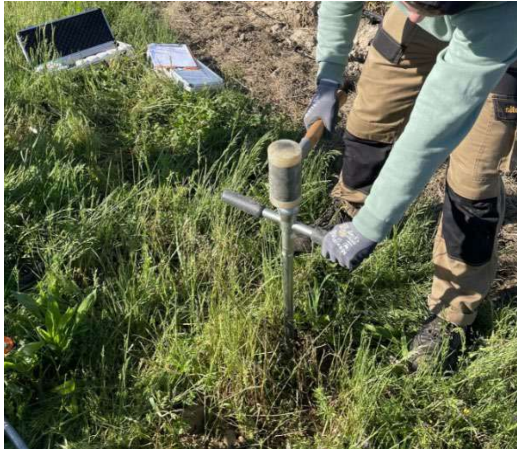
Mediciones: Cilindro de tierra para calcular la densidad aparente
