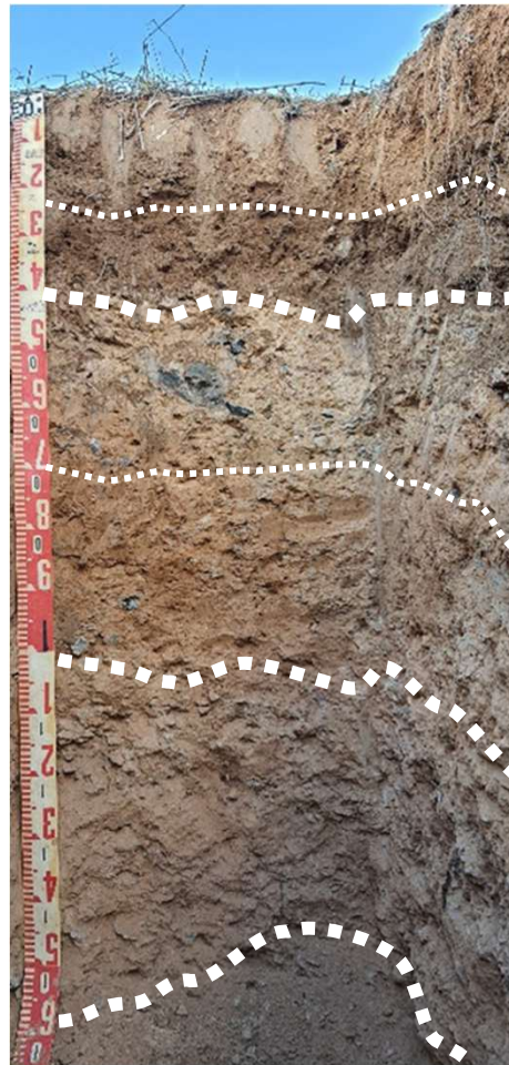
Conglomerados de Fitero (Terciario-Mioceno) gravas y materiales finos coluviales
