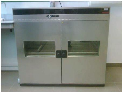
Fotografía 1. Estufa de secado Memmert UFE 800/700.
