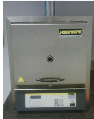
Fotografía 2. Horno mufla Nabertherm LVT 15/11.
