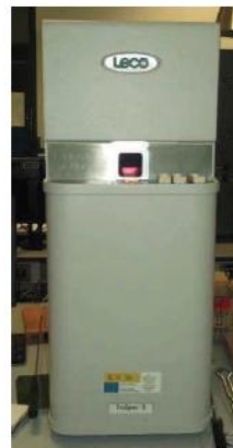
Fotografía 6. Analizador LECO TruSpec S 630-100-700.
