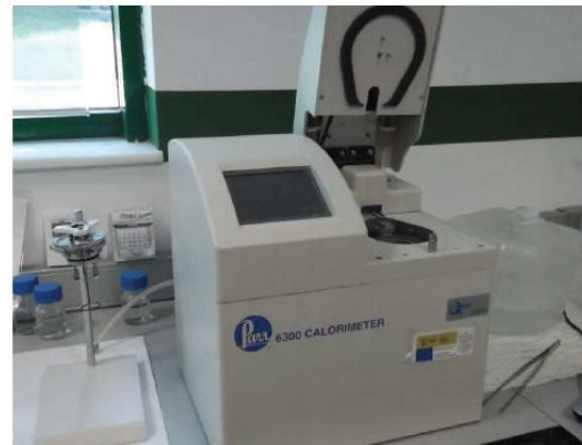
Fotografía 3. Bomba calorimétrica PARR 6300.
